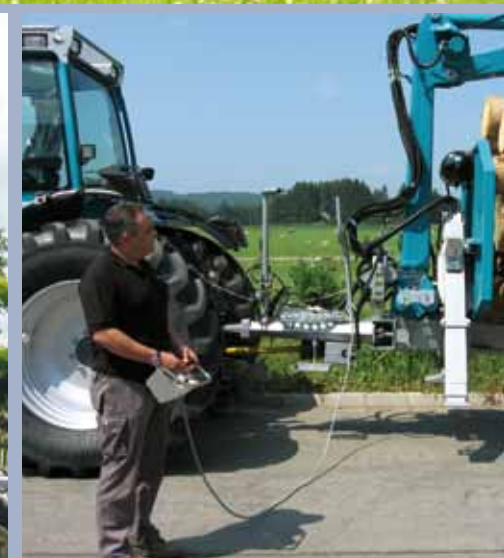
Pfanzelt EHC-Steuerung mit 6 m Steuerkabel in Bauchtragweise
