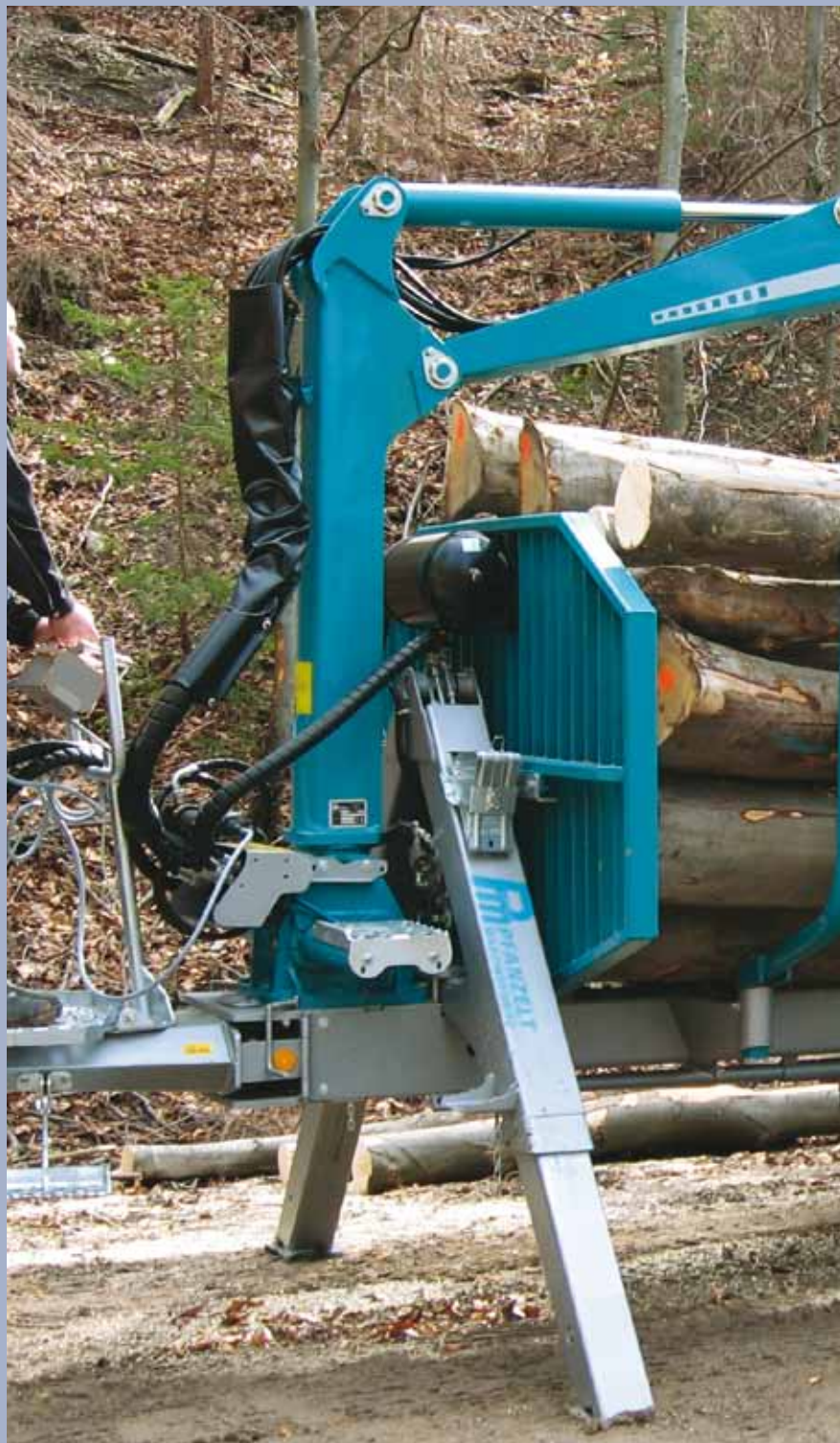
Schwenkbare Deichsel, mechanische Arretierung für Straßenfahrt
