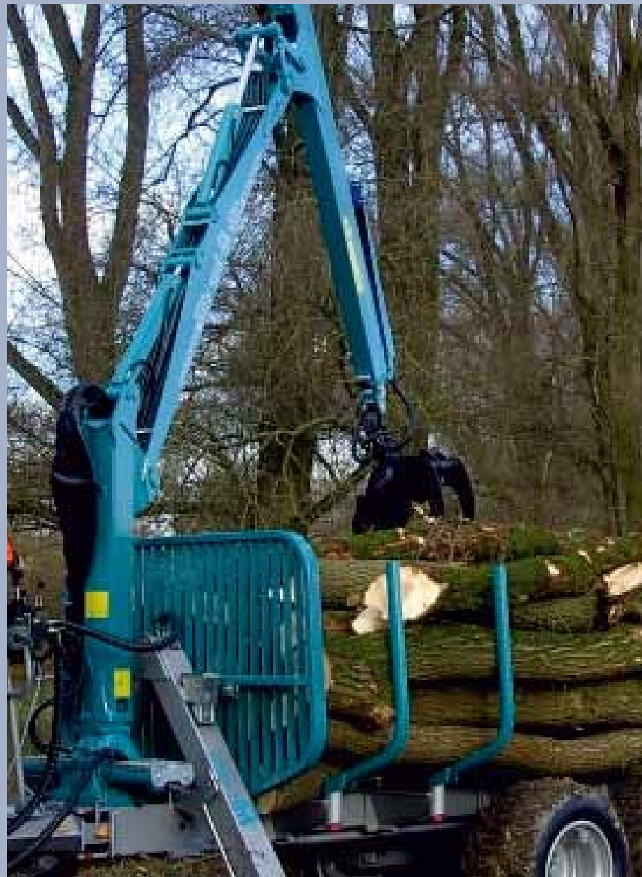
Aufgeräumte und geschützte Schlauchverlegung
