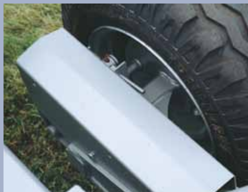
Schutzhaube für Bremsgestänge auf Boogieachse
