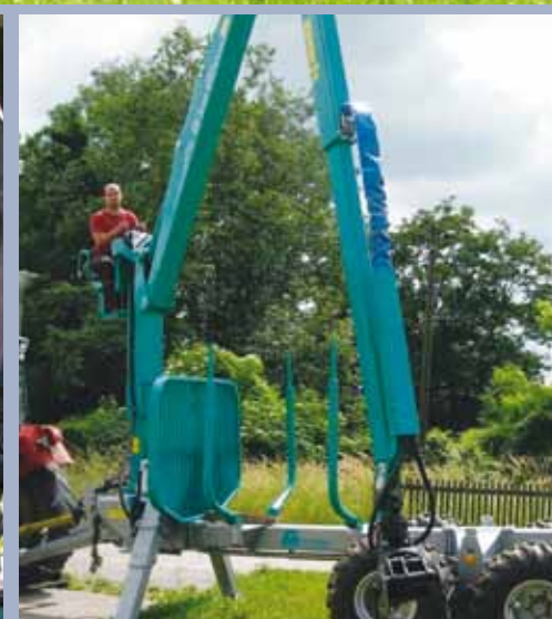
Hydraulisch wird der Hochsitz in Position gebracht
