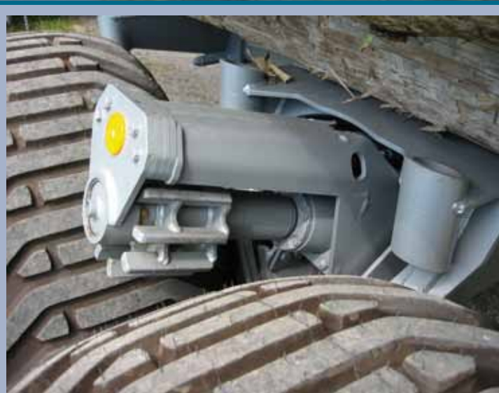
Doppelt gelagerte Druckrolle mit Aufnahmekorb, Geschützt verbauter Motor und Bedienungszylinder
