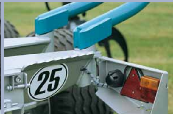
Beleuchtung geschützt im Rahmen integriert
