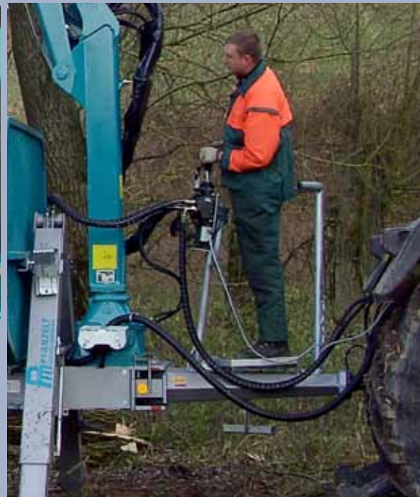
Bedienerstand mit Rückenlehne (Verkleinerter Schwenkbereich des Ladekranes bei Bedienerstand auf Deichsel laut UVV)
