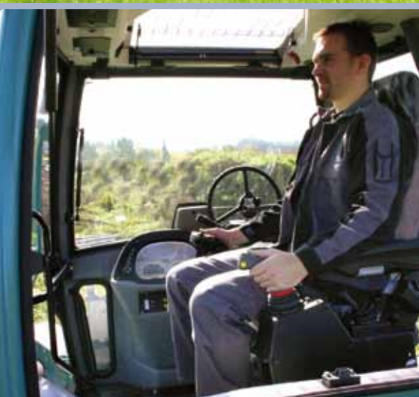
Bedienung des Ladekrans aus der Schlepperkabine mittels Joystick
