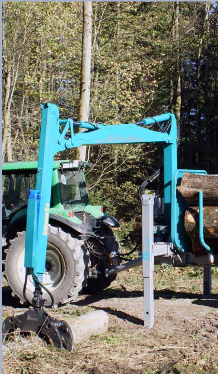
Schwenkbare Deichsel, mechanische Arretierung für Straßenfahrt
