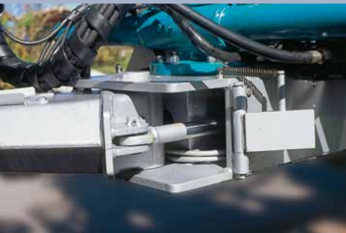
Schwenkbare Deichsel, mechanische Arretierung für Straßenfahrt
