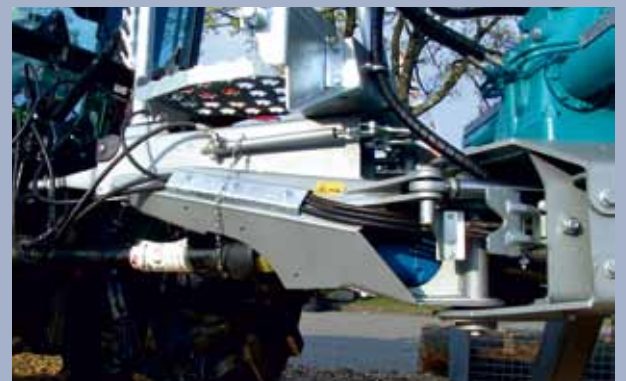
Die auf Wunsch erhältliche Bordhydraulik besteht aus einem verdeckt verbauten Öltank und der in der geschützt in der Deichsel verbauten Axialkolbenpumpe mit 108l Förderleistung und Direktantrieb.
