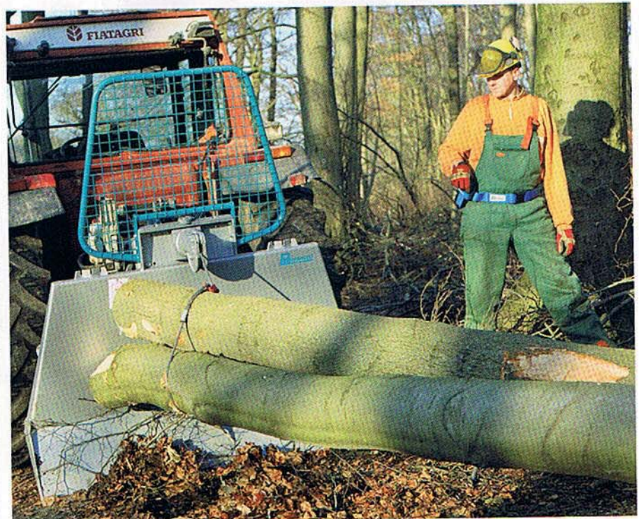
Mit der „S-line“-Baureihe bietet Pfanzelt zwei preiswerte Getriebe-Seilwinden mit maximal 55 bzw. 72 kN Zugkraft, die den professionellen Winden kaum nachstehen. Fotos: Wilmer
