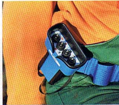
Die senkrechten Kippschalter erschweren die Bedienung, und es fehlte eine Ladeanzeige. Statt in den separaten Köcher steckt man die Einheit besser in die Schlaufe des Gürtels.
