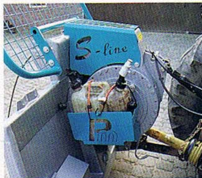
Der Seileinlauf sitzt immerhin 55 cm hinter den Koppelpunkten der Unterlenker (Kat. I/II). Der Halter für den Spritkanister ist prima.
