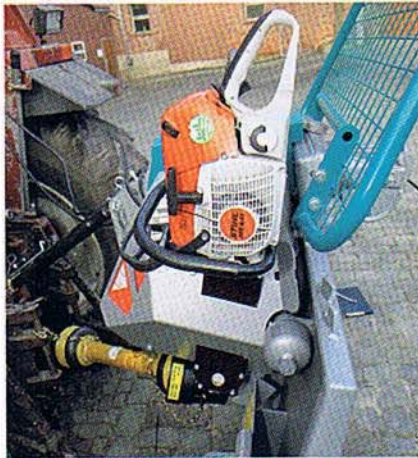
Unter dem Blech verbergen sich ein Stirnrad und ein Schneckengetriebe sowie die Ölpumpe. Es gibt zwei Staukästen mit Deckel sowie einen Halter für die Motorsäge.
