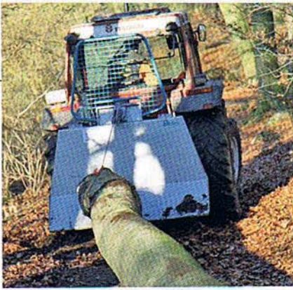
Das Rückeschild aus Feinkornstahl ist stabil konstruiert. Wir hatten die 1,80 m breite Variante. Serie sind 1,50 m, maximal möglich sind 2,20 m.
