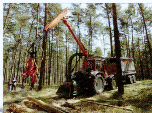
Der Pm Trac 2395 mit Ladekran 51100 und Fällgreifer.
