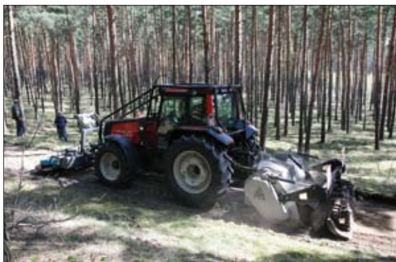
Abb. 6: Valtra-Schlepper mit FAE-Fräse und Brandl-Plattenverdichter
