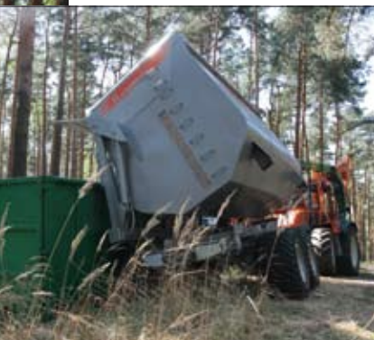
Abb. 1 u. 2: Der Pm-Trac II 2395 mit NHS-Scheibenhacker, 10-m-Kran, Energieholzaggregat Naarva-Grip und Chiptrailer. Entleert wird der Container an der Waldstraße seitlich in Lkw-Container. Die Kipphöhe beträgt 2,75 m.
