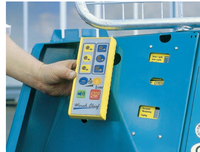
Handsender mit übersichtlicher Folientastatur zur Bedienung der Seilwinde (Funktionen: „Winde“ ziehen, Stopp, lösen, kurz lösen, Gas +/-). Der Empfänger ist geschützt an der Seilwinde integriert (nur lieferbar bei „F“ Typen)
