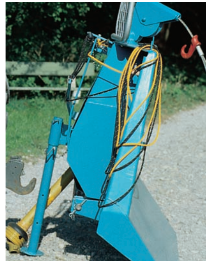
Einfache Bedienung der Kupplung und Bremse über Seilzüge
