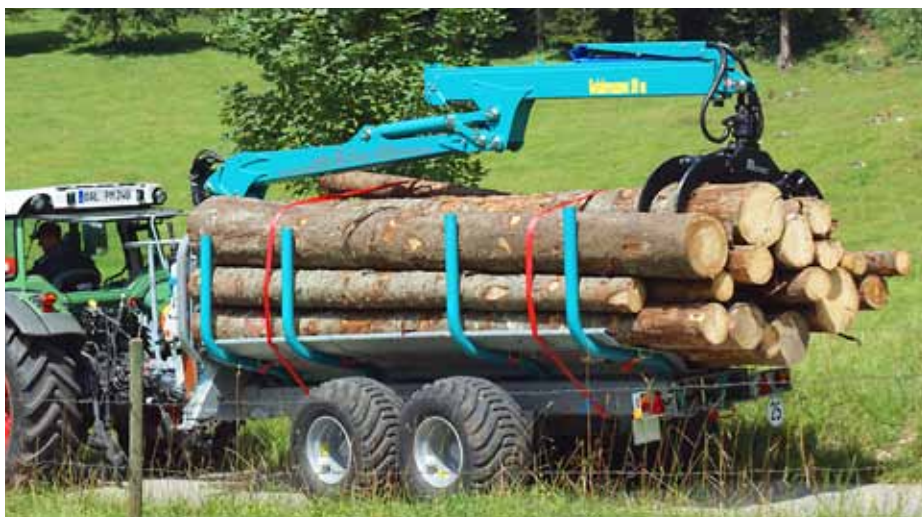
Abb. 4: Bei beladenen Straßenfahrten ist eine Auflauf- bzw. Druckluftbremsanlage gesetzlich vorgeschrieben.
