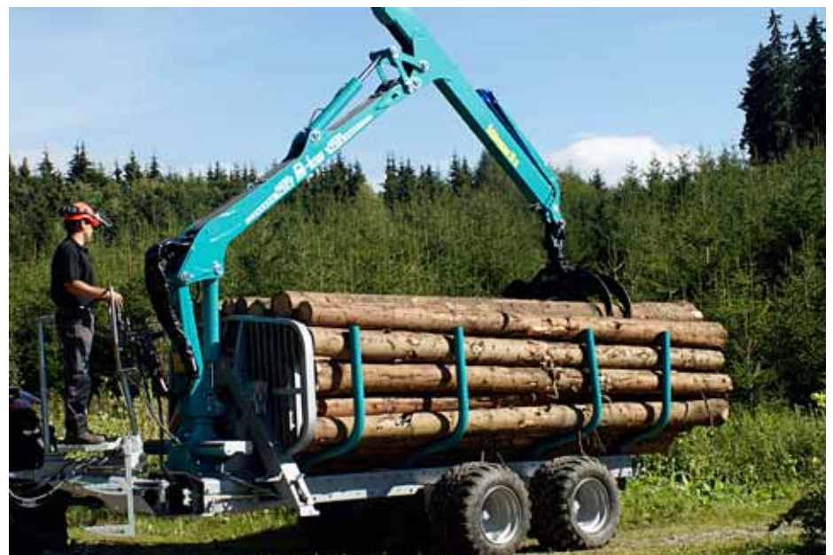
Abb. 3: Ergonomischer Aufstieg, Rückstütze und Handschutz sind vom KWF bei Bedienständen vorgeschrieben.
