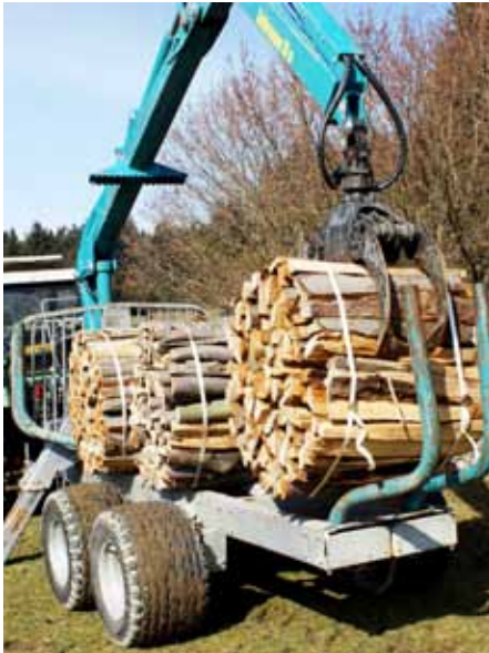
Abb. 2: Beim S-line Rückeanhänger sind auch Querladungen durch die um 90° drehbaren Rungen möglich.
